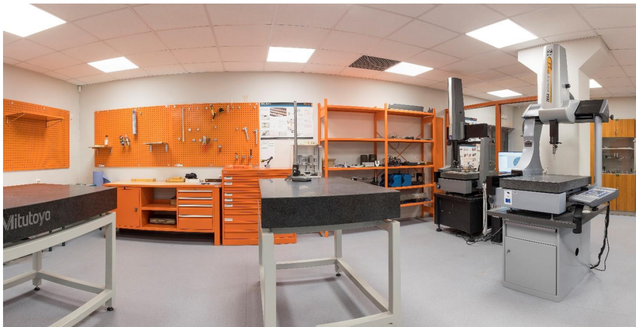
Pilt 5. CMM-id Tehnikakõrgkooli mõõtetehnika laboris. Foto: autor
