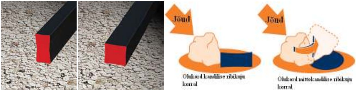
Joonis 23. Võrgu ribide efektiivne geometria
