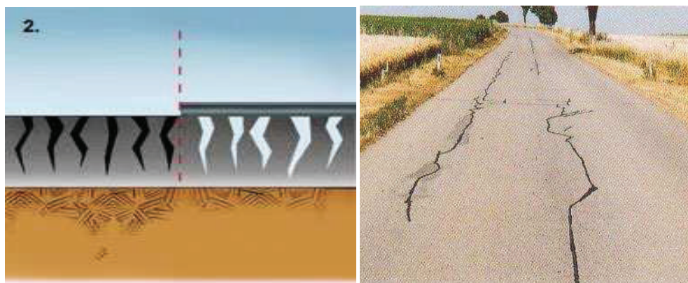
Joonis 34 Tee aukude, pragude täitmine [9] [10]
