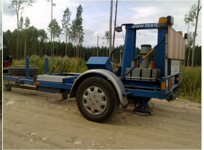
Foto 2. FWD-mõõteaparaat, mõõtmine Udriku teel
