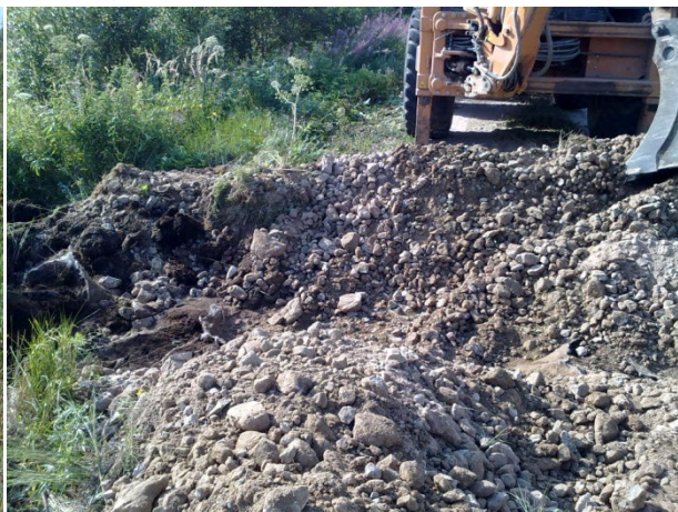
Foto 6. Kaevatud surf ja katkine geotekstiil
