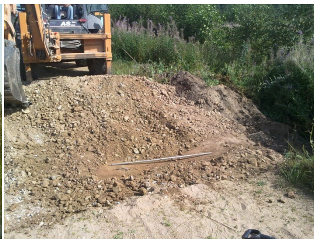
Foto 10. Kaevatud surf; teekatend on väga liivane
