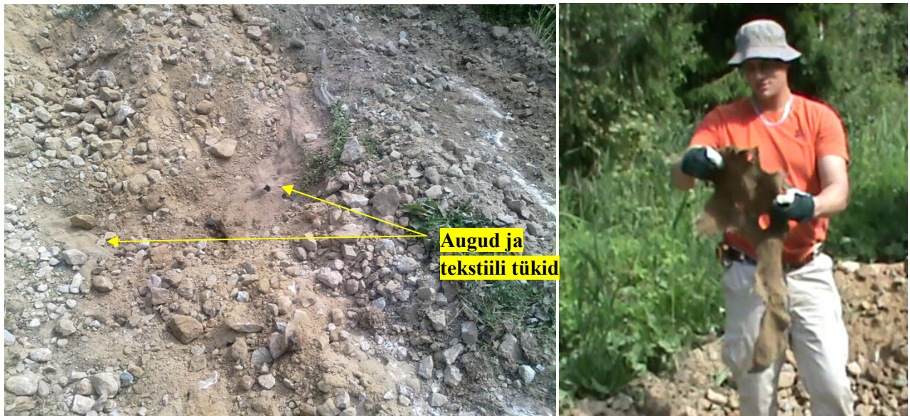
Foto 35 ja 36. Aheraine on nõrga aluse peale paigaldatud ning antud kohta mitesobiva geotekstiili lõhkunud
