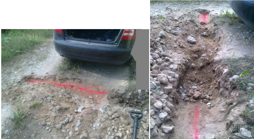
Foto 17 ja 18. Pealmine liiv (kuni 5cm) ja selle all olev väga kõva konstruktiivne kiht (u. 30cm)
