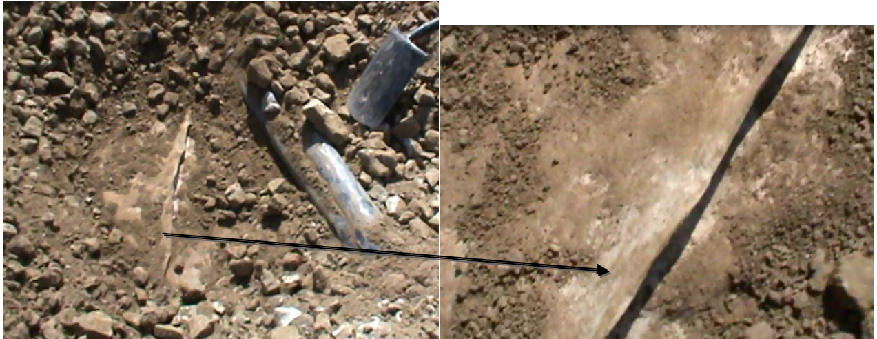
Foto 41 ja 42. Tee sisse maetud geotekstiili pakkerull. Tekstiil ise on nagu uus, kortsus ääre all polnud materjal isegi värvi muutnud; asukoht 800m Rakvere-Mustvee maanteest.
