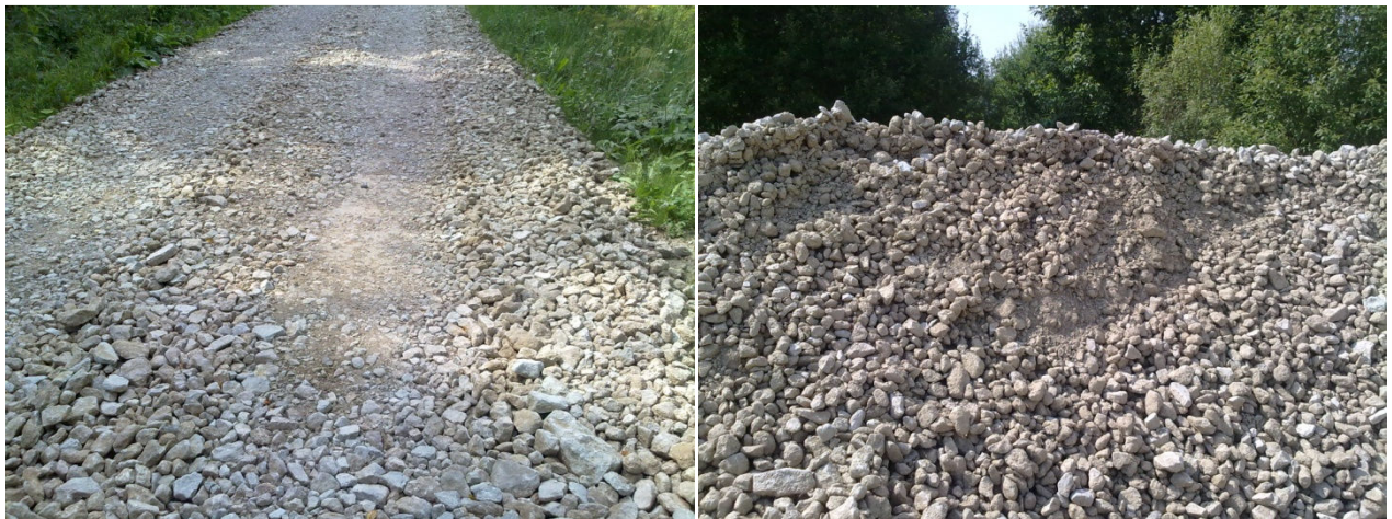
Foto 47 ja 48. Aherraine sisaldab visuaalsel vaatlusel kõvasti saviosiseid
