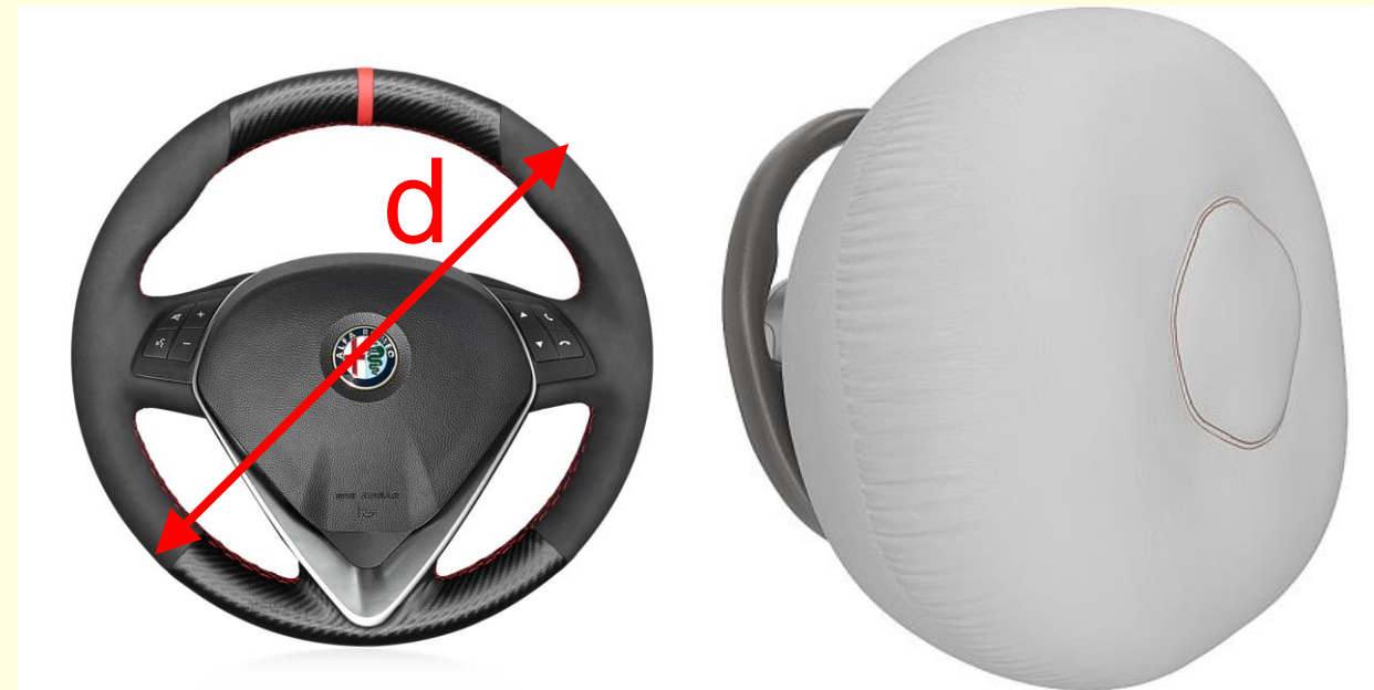
Tavasõiduauto rool sisaldab juhi turvapadja moodulit
