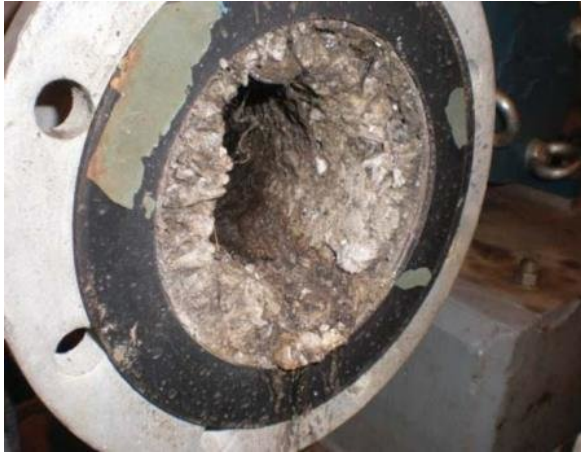
Joonis 17.34. Näide struviidi sadestumisest kääríti torus [20]
