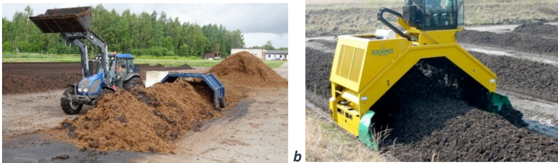
Joonis 17.23. Aunapöörliid: a – järelveetav COMPOST and WASTE Technology ST-300 Võrus, b – liikurpööril BACKHUS Tartu reoveepuhasti kompostimisväljakul (Fotod: M. Kriipsalu)
