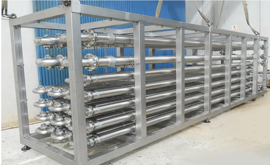
Joonis 17.33. HRS Heat Exchangers Ltd DTR seeria toru-torus-soojusvaheti [18]
