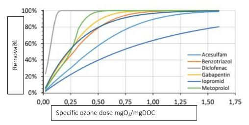
Figure 15. Specific ozone doses to remove certain APIs. (DWA rule book T2/2022 "Einsatz der Ozonung zur Spurenstoffentfernung auf kommunalen Kläranlagen — Erfahrungen, Verfahrens-Technische aspects and Offene Fragen").
