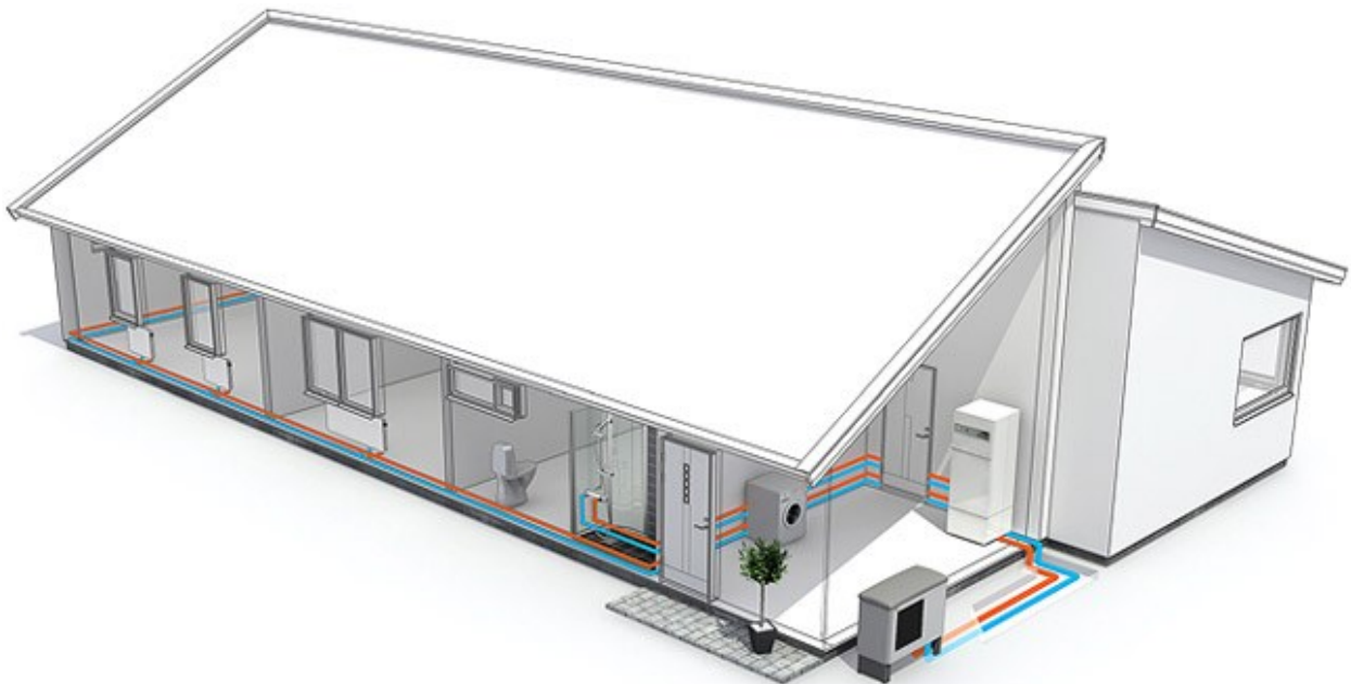
Joonis 6.7. Välisõhu õhk-vesi-tüüpi soojuspump (www.nibe.ee).
