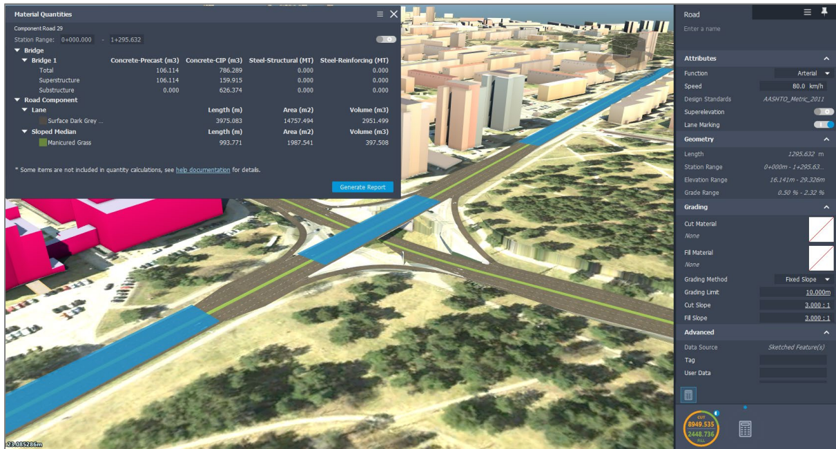
Joonis 13. Too välja viaduktiga sõidutee materjalide mahud. Pane tähele, et ristmike selle juures veel ei ole arvestatud: https://help.autodesk.com/view/INFMDR/ENU/?guid=GUID-9574DECC-9CA7-4900-98F8-FE12BAED5951
