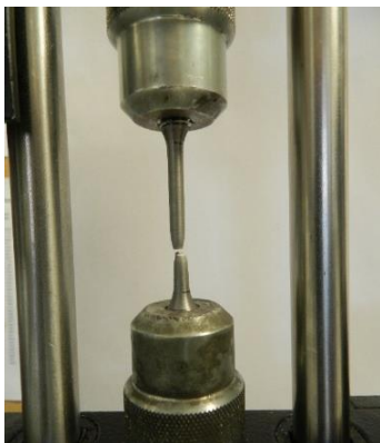
Foto 32. Terase voolavustugevuse ja tõmbetugevuse määramine purustava katsetamisega
