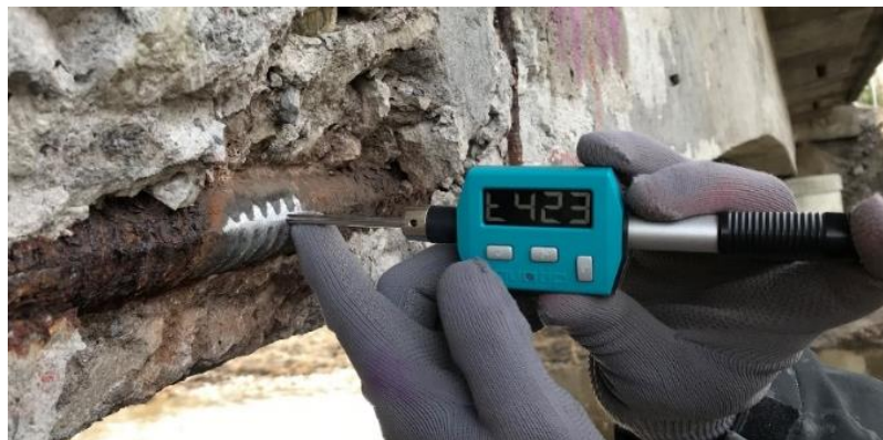
Foto 33. Terase tõmbetugevuse kaudne hindamine mittepurustava katsetamisega
