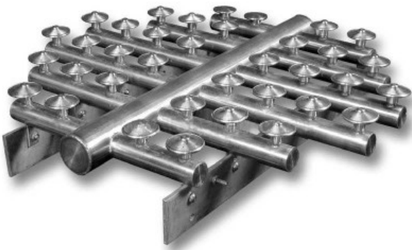
Joonis 16.4. Terasest pilukuplid terasest jaotustorustikul [5]
